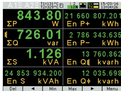
8 Parameter in jeder der 10 Displayseiten; Möglichkeit der Farbänderung für alle Displayseiten
